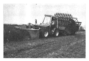
Fig. 5: Le Terratrac TT 77 AEBI exécutant la récolte quotidienne de l'herbe avec une faucheuse rotative PZ et une remorque autochargeuse Fella.
