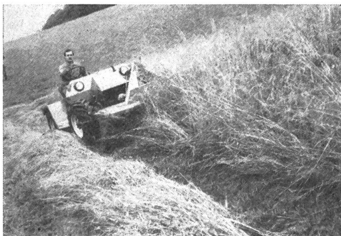
Fig. 8: Ce véhicule d'une puissance de 52 ch a été spécialement conçu pour rouler sur les pentes. Sa bonne garde au sol et ses pneus à profil agraire contribuent aussi à lui assurer une grande capacité de traction.
