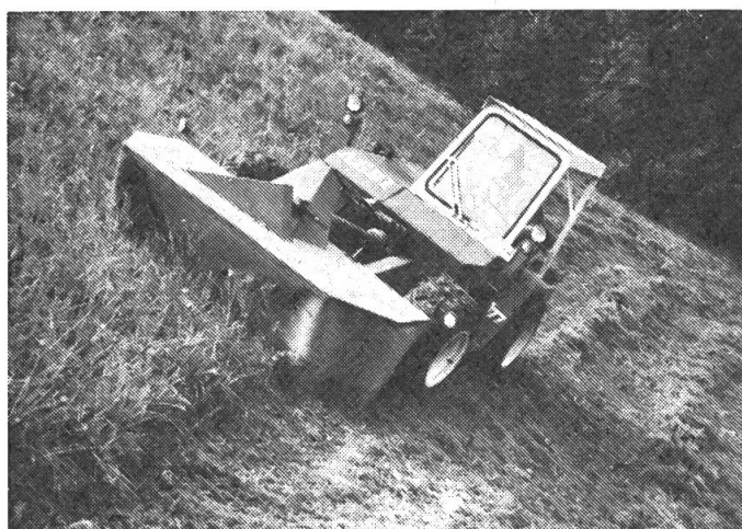
Fig. 7: Cette machine de travail offre également une grande sécurité de roulage sur les terrains inclinés. A relever qu'il vaut mieux travailler selon le sens de la pente sur des champs de très forte déclivité.
