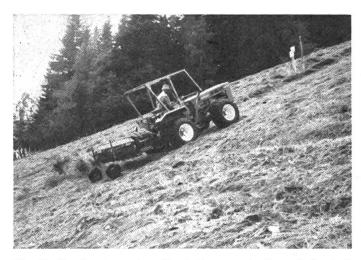
Fig. 9: Ce tracteur à articulation centrale est équipé de pneus Terra (à basse pression). Lors de démonstrations de machines, il a montré qu'il possède de bonnes aptitudes pour rouler sur les terrains déclives selon le sens de la pente.
