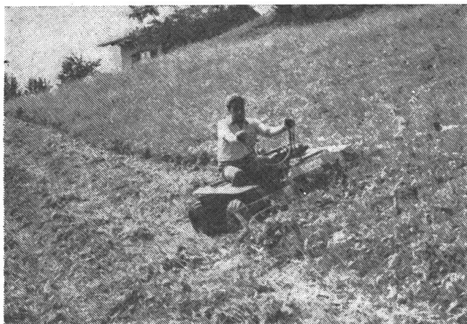
Fig. 6: Le bas centre de gravité et les pneus adhérents à basse pression de cette machine lui assurent une remarquable stabilité sur les terrains en pente.
