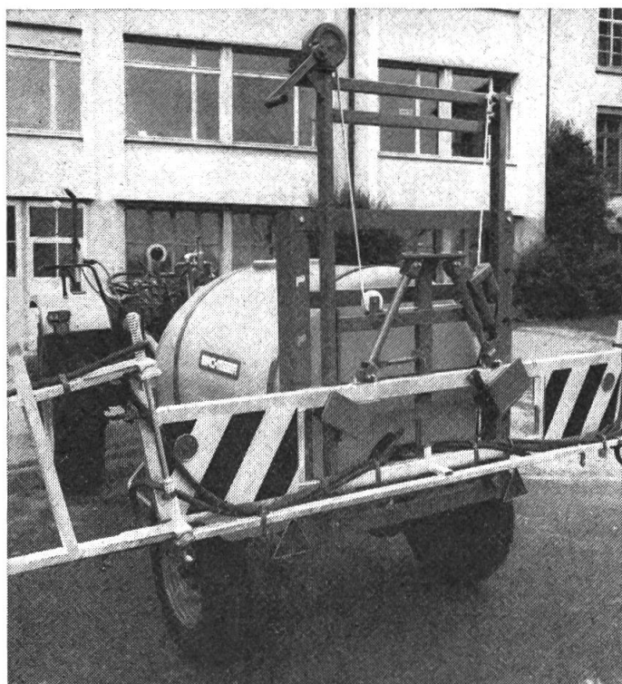
Fig. 4: Rampe pulvérisatrice à compensation pendulaire et réglage en hauteur par treuil à câble (Birchmeier).
