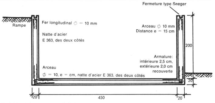
Fig. 2: Plan de l'armature d'un silo horizontal.
