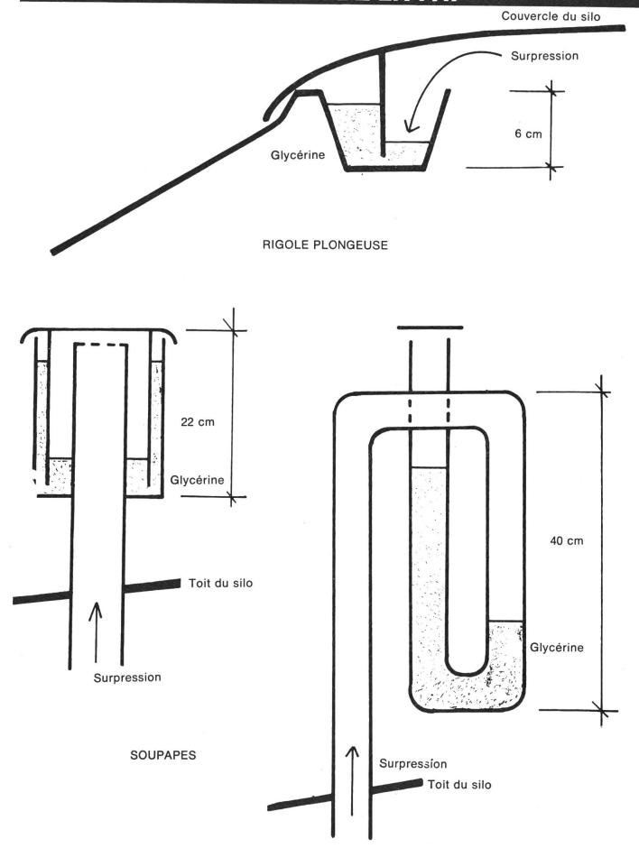
Fig. 4: Rigole plongeuse et soupapes sur le silo.
