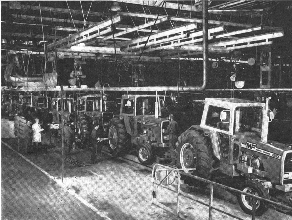
Fig. 4: Les cabines de sécurité à incorporer aux tracteurs sont préfabriquées à l'usine de Marquette-lez-Lille puis complètement équipées et montées ici.
