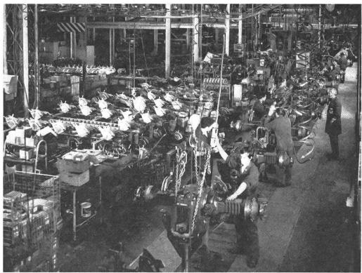
Fig. 3: C'est ici que sont assemblés les dispositifs de relevage hydraulique, les ponts arrière et les boîtes de vitesses.
