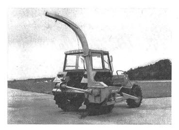
Fig. 1: La faucheuse-hacheuse-chargeuse Claas Jaguar 3 avec tambours d'introduction disposés verticalement et tambour à couteaux également vertical.
