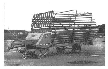
Fig. 3: L'autochargeuse Claas Autonome T 25. Il s'agit d'une machine à châssis surbaissé qui comporte un mécanisme chargeur à chaînes à râteaux, un dispositif de coupe à tronçonnage court et des ridelles métalliques.
