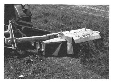
Fig. 2: La faucheuse-conditionneuse Claas WM 20 C, machine à tambours rotatifs, a une largeur de coupe de 1 m 65.
