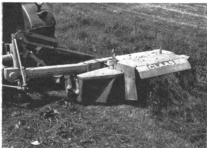
Fig. 2: La faucheuse-conditionneuse Claas WM 20 C, machine à tambours rotatifs, a une largeur de coupe de 1 m 65.
