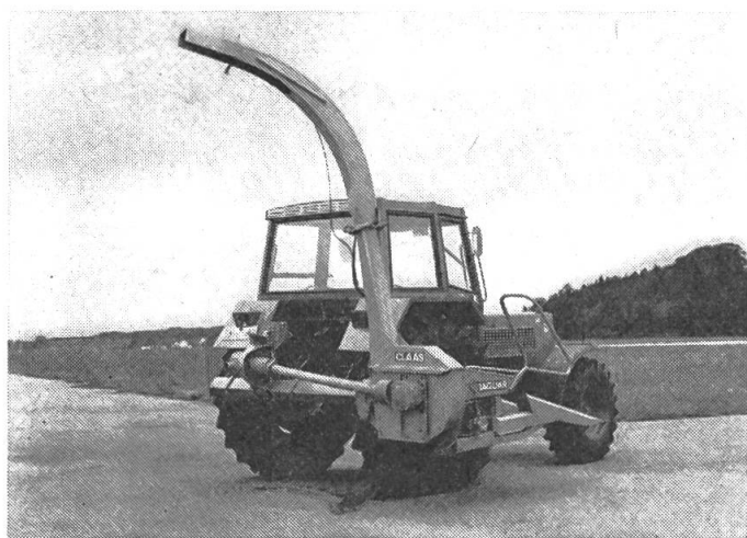
Fig. 1: La faucheuse-hacheuse-chargeuse Claas Jaguar 3 avec tambours d'introduction disposés verticalement et tambour à couteaux également vertical.
