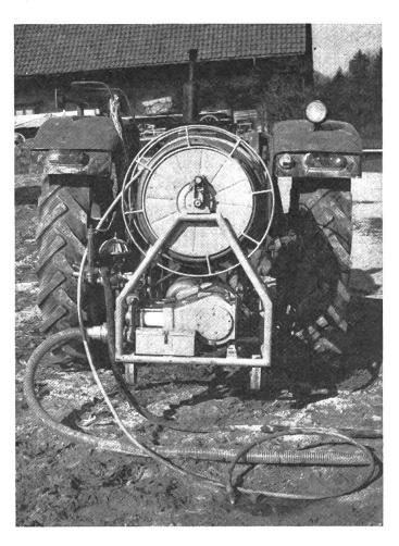
Cureuses de tuyaux de drainage: Caractéristiques techniques:
