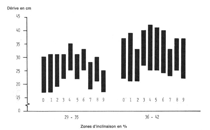
Fig. 5: Zones de dérive des pneus nos. 0 à 9 soumis à des essais sur des pentes d'un taux d'inclinaison allant de 29 à 42%.
