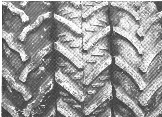
Fig. 7: De hautes barrettes de traction à arêtes vives et de grandes gorges d'autonettoyage au centre de la bande de roulement (au milieu) donnent de très bons résultats dans les terrains meubles difficiles et plats. Lorsqu'on roule selon le sens des courbes de niveau, les pneus comportant des barrettes de traction moins hautes et à grande surface se montrent plus avantageux (à gauche et à droite).
