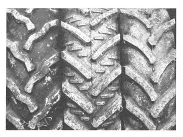
Fig. 7: De hautes barrettes de traction à arêtes vives et de grandes gorges d'autonettoyage au centre de la bande de roulement (au milieu) donnent de très bons résultats dans les terrains meubles difficiles et plats. Lorsqu'on roule selon le sens des courbes de niveau, les pneus comportant des barrettes de traction moins hautes et à grande surface se montrent plus avantageux (à gauche et à droite).
