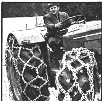
Chaînes à neige en acier spécial mordant, extra-solides pour tracteurs agricoles
