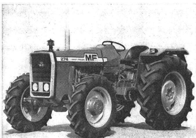
La prise de force indépendante de 540 et 1000 t/min. est enclenchable sous charge; elle est complétée d'une prise de force dépendante de l'avancement. La direction est hydrostatique. Les freins sont à double disque.
