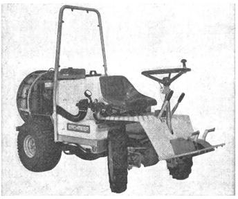
tés, avec ventilateur, est ainsi complète. A ce propos, il y a lieu de mentionner plus particulièrement le RADIAX 800/1000-F, dont le ventilateur a été monté devant. Ce modèle de pulvérisateur représente le seul qui aspire l'air à l'avant et empêche ainsi une réaspiration du brouillard formé par le produit pulvérisé. Les buses peuvent être mises individuellement hort fonctionnement et sont pourvues de valves antigoutte.
