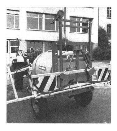
Notre stand comportera aussi divers modèles de la gamme des pulvérisateurs portés AGROPORT. Il s'agissait notamment du modèle BIRCHMEIER AGROPORT-J, machine de prix accessible avec réservoir à bouillie de 500 litres et pourvue d'une pompe à 3 pistons-membrane (pression: 100 1/20 bar), ainsi que du modèle répondant aux plus grandes exigences du point de vue de la technique et des performances équipé de la pompe à pistons BIRCHMEIER la plus puissante.
