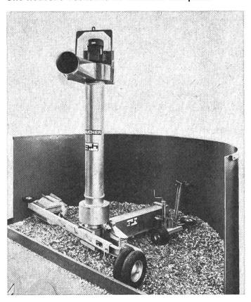
Cette nouvelle désileuse en acier fin inoxydable se caractérise avant tout par sa capacité d'extraction du fourrage qui est au-dessus de la moyenne et par la faible puissance qu'elle nécessite. Le ventilateur d'apiration se trouve directement sur la fraiseuse, ce qui accroît la capacité d'aspiration et la sûreté de fonctionnement. Du fait de la structure simple de cette désileuse, il a été possible de maintenir son prix de vente à un niveau sensiblement bas.
