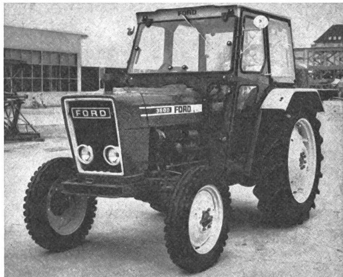
A ceux qui sont gênés dans leur ferme par des passages à hauteur réduite, Ford propose un cadre de sécurité extrêmement bas (par exemple le Ford 2600 avec 2,06 m de hauteur totale ou le Ford 5600/6600 avec 2,43 m) pouvant être complété par des éléments supplémentaires jusqu'à une cabine complète.
