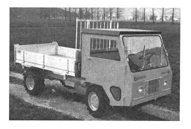
Elle présente comme nouveauté le type agricole du transporteur 2200 à direction hydrostatique ZF équipé d'un chargeur produit en commun. En outre, la SCHILTER SA démontre la polyvalence du tracteur universel UT 6502 au moyen de leur VEHICULE FORESTIER attelé à un même tracteur. (Trad. H.O.)
