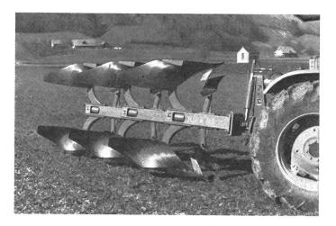
problèmes en charrue bisocs grâce au système de construction par blocs. Le système de déclenchement hydraulique permet le labourage dit NON-STOP.
