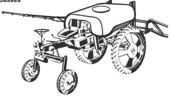
Ce genre de pulvérisateur automoteur, muni d'un moteur Diesel à deux cylindres et prévu pour de multiples usages, est absolument nouveau en Suisse.
