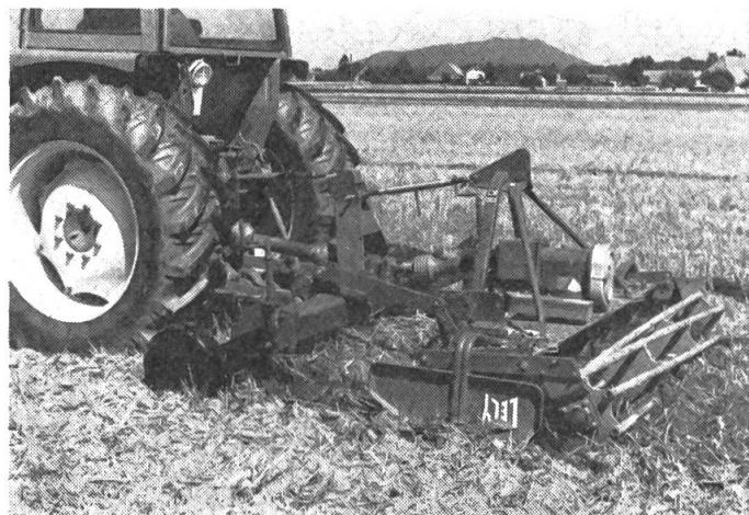
Le COMBIFIX est un cultivateur lourd pour le travail en couches avec des dents rigides. Il a un bâti avec attelage rapide et support pour prise de force réglable. On peut fixer jusqu'à 7 dents en deux rangs et deux différentes profondeurs. La profondeur peut être réglée avec deux roues ou avec le contrôle de profondeur hydraulique du tracteur. La largeur de travail est de 250 cm.
