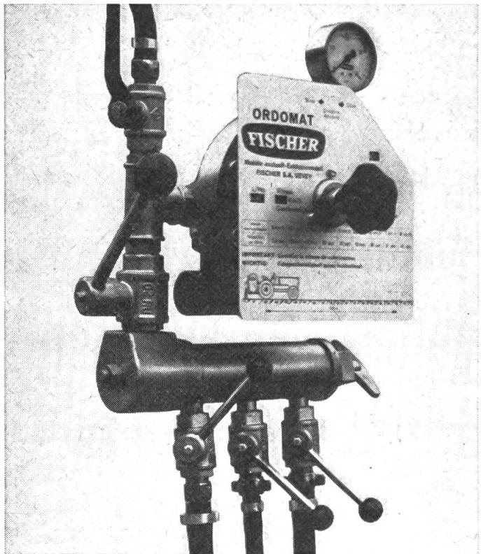
En tant qu'appareil de la nouvelle génération, l'ORDOMAT vient remplacer tous les types d'appareils doseurs automatiques réalisés jusqu'à maintenant par la Fabrique Fischer. Son montage est extrêmement facile et peut être effectué sur tous les pulvérisateurs de cette firme.
