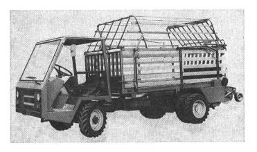
dèles sont munis d'une boîte de vitesses synchronisée. En ce qui concerne les deux plus grands, ils comportent une boîte de vitesses à renversement de marche avec 8 marches avant et 8 marches arrière. Un système de blocage du différentiel se trouve tant à l'avant qu'à l'arrière. Enfin la tableau de bord, de conception moderne, a été bien disposé et offre une bonne vue d'ensemble.
