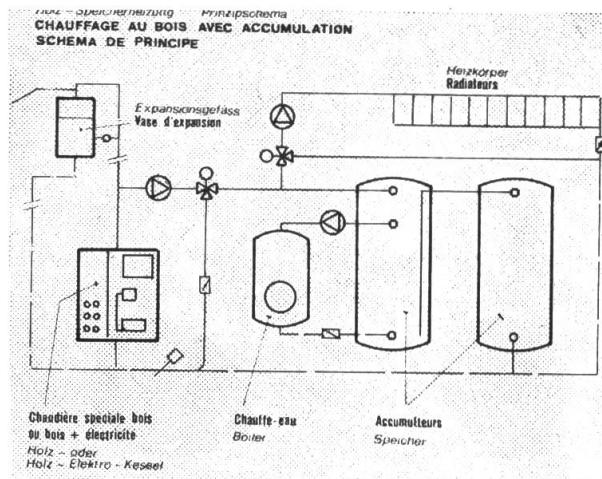
les radiateurs est stockée dans les réservoirs. La chaudière fonctionne ainsi à plein régime, ce qui élimine les problèmes de goudronnage et de condensation. Lorsque la charge de bois est consommée, le chauffage fonctionne alors sur l'accumulation. Autre avantage de ce système: une diminution importante des chargements de la chaudière, par exemple tous les deux jours aux entre-saisons avec une installation bien proportionnée. Le système peut également être combiné avec le chauffage électrique.
