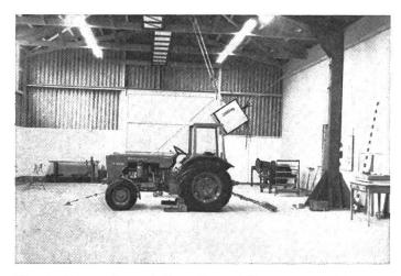
Fig. 4: Banc d'essai des dispositifs de sécurité pour le conducteur, à Tänikon.
