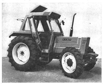
faibles trépidations, cabine chaude en hiver et fraîche en été, plus grande protection contre les accidents. Tous les modèles peuvent être obtenus avec un ou deux essieux moteurs et direction hydrostatique. Lors de la présentation des divers cadres de sécurité et toits-abris au stand en question, les intéressés ont également pu voir de près le cadre de sécurité rabattable prévu pour les garages et les entrées de hauteur réduite. Trad. R.S.
