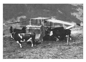
Cette salle de traite mobile est pourvue de tous les équipements nécessaires pour la traite mécanique. Etant donné son poids de 800 kg, elle peut être également montée sur des chars automoteurs de type léger.
