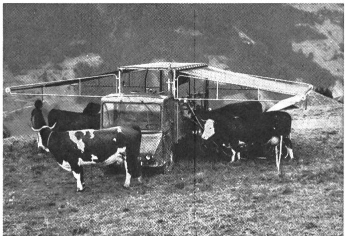
Cette salle de traite mobile est pourvue de tous les équipements nécessaires pour la traite mécanique. Etant donné son poids de 800 kg, elle peut être également montée sur des chars automoteurs de type léger.
