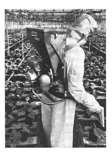
pulsés au moyen d'un courant d'air. D'autre part, on a prévu une commande manuelle pour une distribution ponctuelle ou sur bandes ainsi qu'un régulateur de vitesse pour le moteur.
