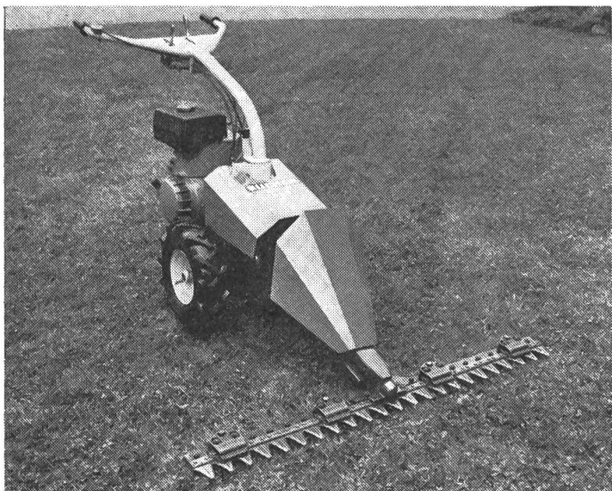
Fig. 2: Voici comment se présente la nouvelle petite motofaucheuse BUCHER M 50. Elle est particulièrement maniable et rapide. De plus, elle offre une très grande facilité de manipulation des commandes.
