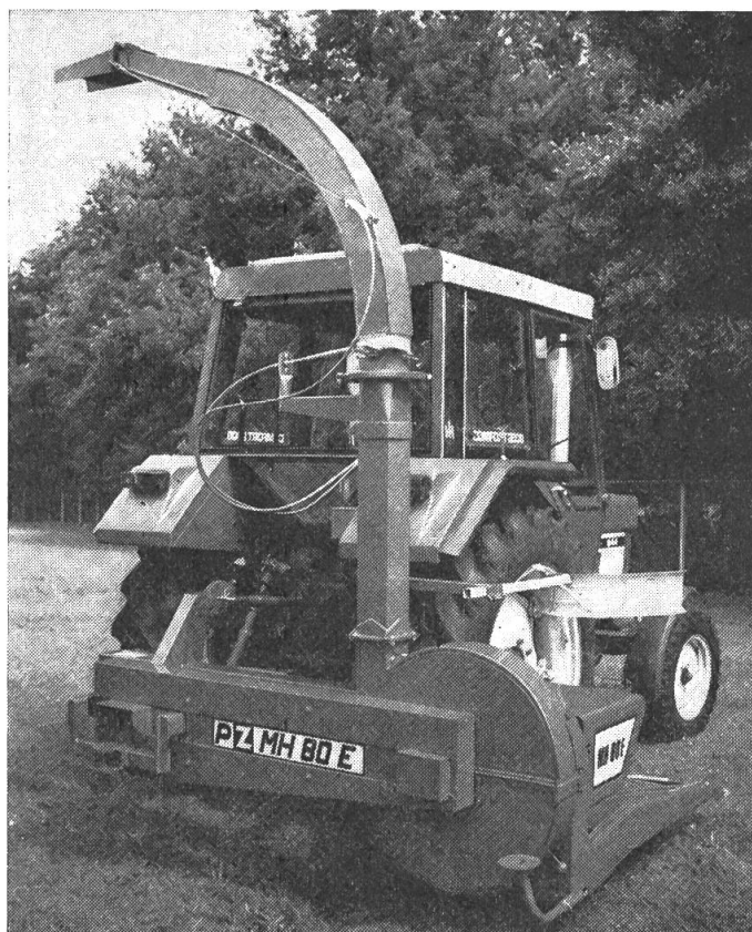
Fig. 3: Récolteuse hacheuse Fahr MH 500 pour le maïs-fourrage. Cette machine de type portée, qui exécute un hachage de précision, comporte un ruban d'alimentation spécial.
