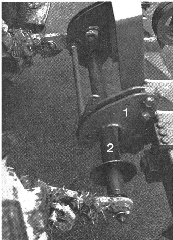
Fig. 2: Les crochets d'attache montés sur l'outil et l'essieu porteur démontable facilitent le raccord du bras inférieur, sans devoir descendre du tracteur.
