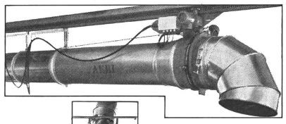
Distributeur pour silos AEROMATIC fonctionnant par l'air
