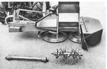
Faucheuse à tambours rotatifs avec condition- suivant les besoins: pour **neurs:** Fauchage propre le fauchage ou bien pour très bon condition-faucher et traiter. nement du fourrage. Le rotor de traitement peut être monté et démonté en un tour de main et la
