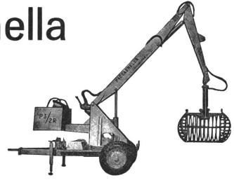
ACCESSOIRES: griffe à fumier, benne à betteraves, pelle à terre, rétro commande hydraulique pour chaque accessoire.
