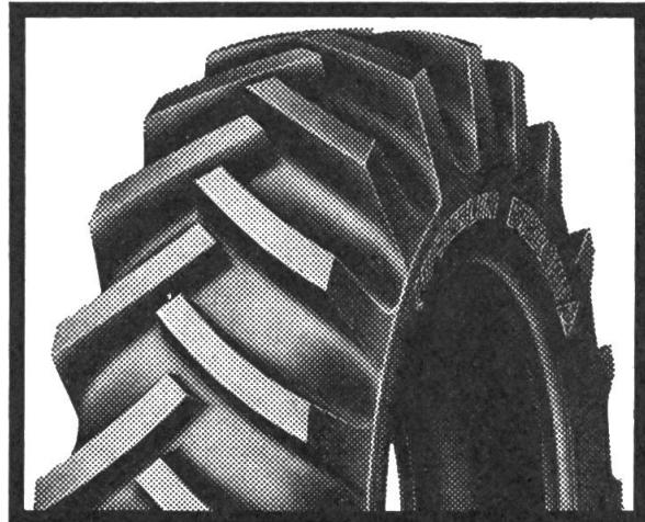
Tout en conservant les qualités d'adhérence bien connues du Bibagrip, Michelin résout, avec ces deux nouveaux types d'enveloppes, le difficile problème de l'usure des pneumatiques montés sur les roues motrices des tracteurs utilisés sur sols durs (route, chemin de ferme...).
