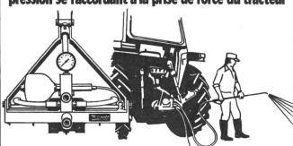
Vous avez ainsi à bien meilleur compte un nettoyeur haute pression, puissant et mobile. Il suffit de quelques gestes pour brancher l'appareil KLINETT, qui offre les mêmes avantages que les modèles normaux: il nettoie, désinfecte, sable. S'emploie aussi pour blanchir les écuries à la chaux. Débit d'eau 780 l/h à 430 t/min. à la prise de force.
