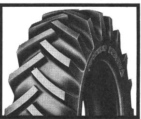
Tout en conservant les qualités d'adhérence bien connues du Bibagrip, Michelin résout, avec ces deux nouveaux types d'enveloppes, le difficile problème de l'usure des pneumatiques montés sur les roues motrices des tracteurs utilisés sur sols durs (route, chemin de ferme...).
