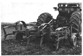
Le cultivateur Automat détruit cette semelle de labour et rétablit ainsi une aération normale du terrain, d'où résulte une amélioration de la structure grumeleuse du sol et des rendements.
