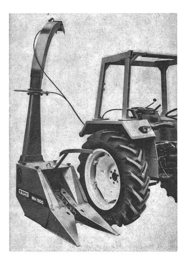
forcés de simplifier les soins et les travaux d'entretien en prévoyant par exemple un groupement des graisseurs sur un tableau de graissage facilement accessible. Les problèmes que présente un rajustage aisé du contre-couteau et de la contreplaque du tambour ont également été résolus d'une façon très satisfaisante. Tous les réglages peuvent être effectués sur le terrain et sans avoir recours à des outils spéciaux.
