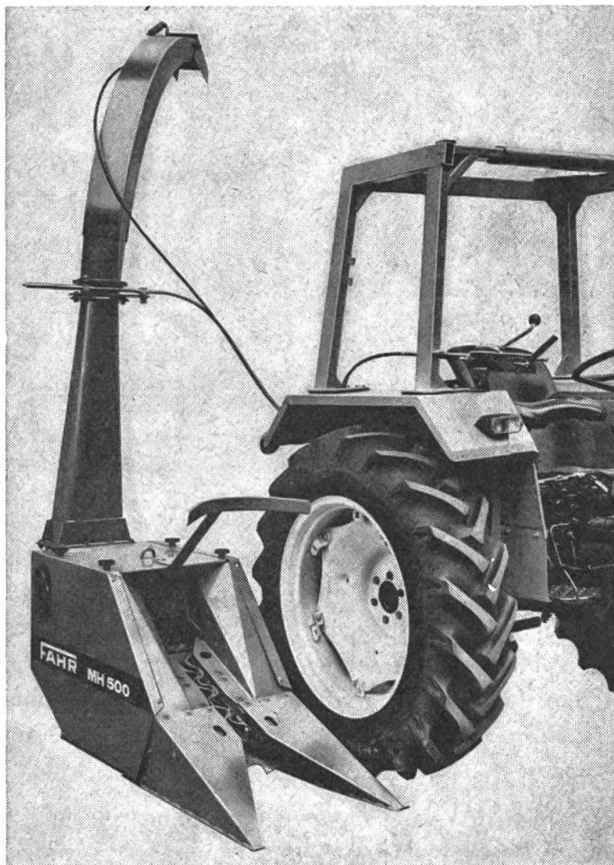
forcés de simplifier les soins et les travaux d'entretien en prévoyant par exemple un groupement des graisseurs sur un tableau de graissage facilement accessible. Les problèmes que présente un rajaillage aisément du contre-couteau et de la contreplaqué du tambour ont également été résolus d'une façon très satisfaisante. Tous les réglages peuvent être effectués sur le terrain et sans avoir recours à des outils spéciaux.
