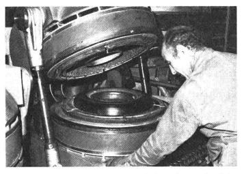
Fig. 4: Le pneumatique est placé dans le moule. A la partie supérieure du moule, on distingue le profil d'un futur pneu à neige.
