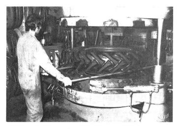
Fig. 6: Un pneumatique de tracteur à la sortie du moule.
