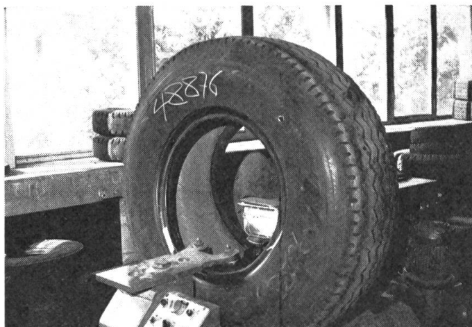
Fig. 1: Contrôle des carcasses. Le pneumatique est éclairé à l'intérieur et tourne lentement pour qu'un homme puisse déceler les dommages éventuels des toiles.
