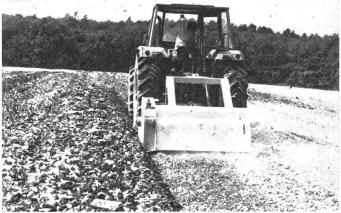
Fig. 2: en haut: Etant donné la profondeur de travail minime du concasseur (2-4 cm), les pierres ont dû être ramassées préalablement à une profondeur de 10-15 cm et ramenées à la surface.
