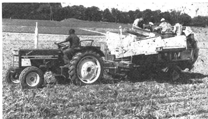
Fig. 5: L'utilisation de récolteuses polyvalentes sur des sols graveleux et criblables est possible, à condition d'avoir épierré le sol préalablement, sinon le taux de travail et l'usure des machines sont très importants.
