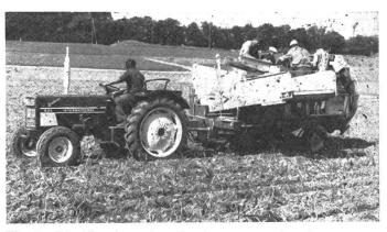
Fig. 5: L'utilisation de récolteuses polyvalentes sur des sols graveleux et criblables est possible, à condition d'avoir épierré le sol préalablement, sinon le taux de travail et l'usure des machines sont très importants.
