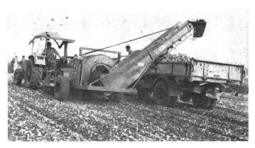
Fig. 1: l'épierrage de sols argileux et difficilement criblable du Jura n'a donné satisfaction qu'en utilisant une épierreuse pourvue d'organes de criblage puissants (bande de criblage et tambour cribleur).
