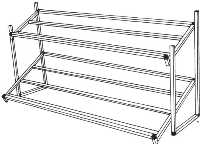
Ce mode d'assemblage nouveau et extrêmement simple offre la possibilité de réduire les frais de transport en livrant des éléments de construction démontés et également celle de pouvoir exécuter un montage simple à l'endroit voulu. En outre, les soudures et les raccords à vis se trouvent supprimés.
