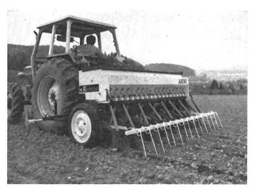
Pour la première fois, une rangée double de dents flexibles peut être montée devant les socs du nouveau ROGER xR-spécial. Ainsi le dernier passage avec la herse avant de semer n'est plus nécessaire. Dans les sols relativement légers, il suffit de faire un simple labourage. Si, vers la fin de l'été, le temps presse, il est alors possible de semer de l'engrais vert ou une «culture dérobée» directement sur le
