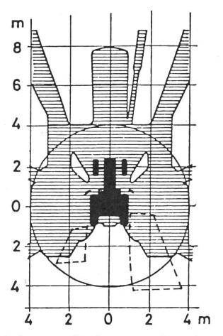
Fig. 7: Les zones d'angle mort pour le conducteur assis peuvent être illustrées et enregistrées au moyen d'ombres portées obtenues, dans un local sombre, à l'aide d'une ampoule allumée au niveau des yeux du conducteur. Les zones en pointillé montrent ce qui peut être vu à l'aide de grands rétroviseurs, accessoires utiles pour améliorer la visibilité et la position du corps pendant le travail.
