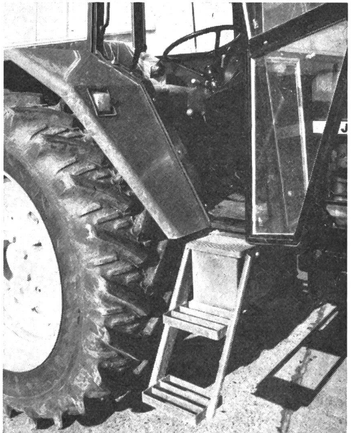
Fig. 5: Ici, même un agriculteur âgé peut monter sur son véhicule sans aucun risque, également avec un manteau et des bottes boueuses.
