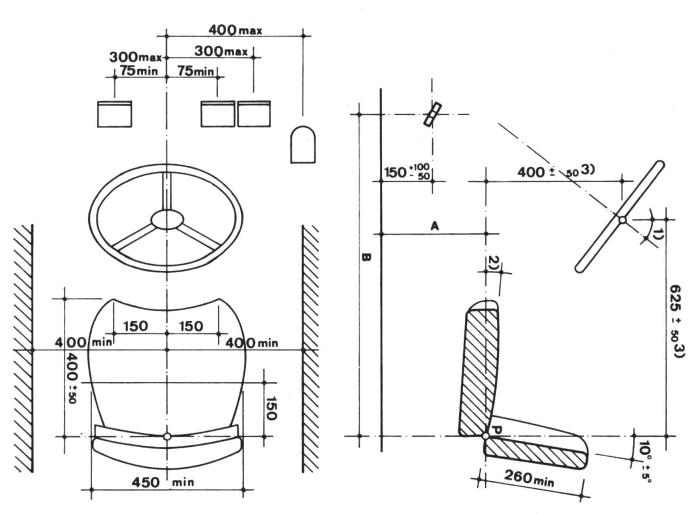
Fig. 2: Mesurages sur le poste du conducteur selon les normes internationales ISO/DIS 4253.
