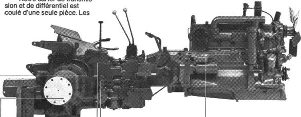
Les pignons à taille hélicoïdale offrent une plus grande surface de contact permettant un fonctionnement plus doux et une meilleure transmission de la puis-
