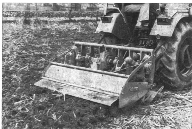
Fig. 2 et 3: Les bèches des modèles CELLI et FALC sont pendulaires et actionnées par un vilebrequin. Ici également les dispositifs de sécurité ne sont pas suffisants.
