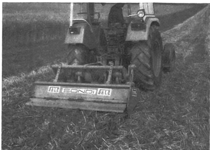
Fig. 2 et 3: Les bèches des modèles CELLI et FALC sont pendulaires et actionnées par un vilebrequin. Ici également les dispositifs de sécurité ne sont pas suffisants.
