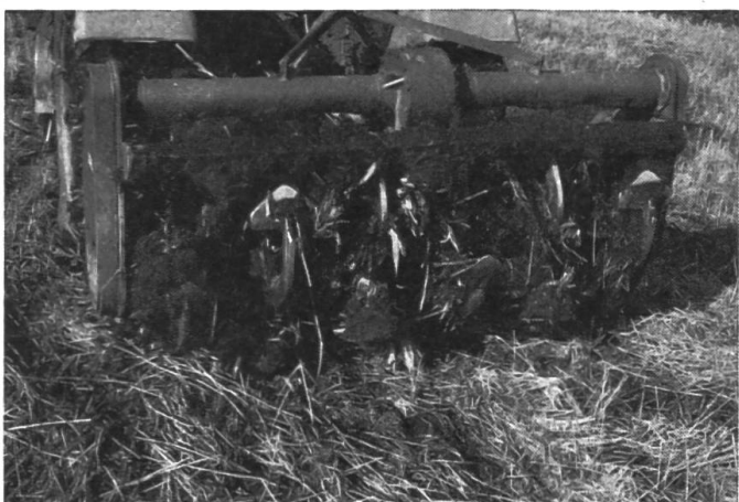
Fig. 8: Des résidus de plantes s'enroulent facilement autour des supports des bèches dans des sols lourds et humides. Le nettoyage des bèches est indiqué, en raison du besoin en puissance qui irait en augmentant.
