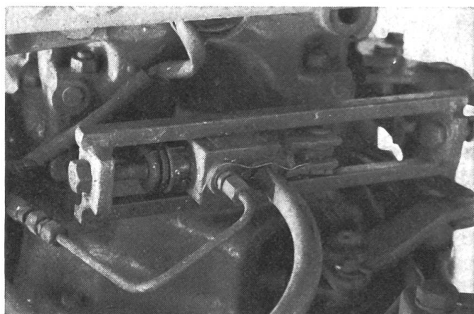
Fig. 2: Actionnée mécaniquement par la pédale de frein, la valve de commande transmet une impulsion à la valve de freinage de la remorque...
