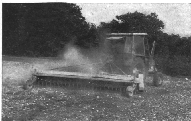
Fig. 10: Un râtelier andainier peut augmenter le rendement de l'épierreur quand il s'agit de sol à taux de pierres minime. Les pierres sont sorties du sol d'une profondeur de 5—10 cm et déposées en forme d'andain.
