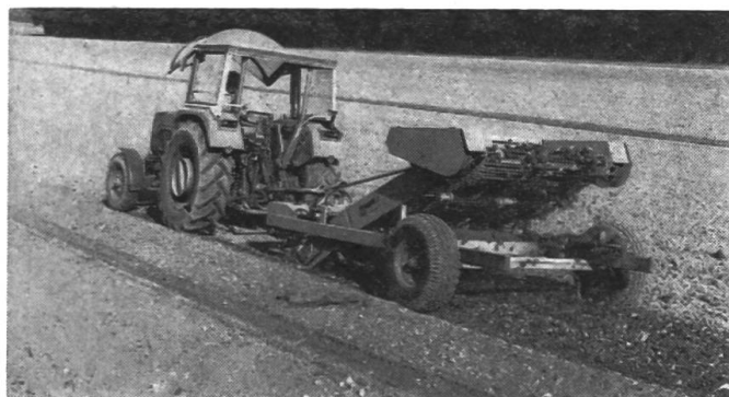
Fig. 11: L'épierreur a ramené les pierres à la surface, d'une profondeur de 10—15 cm; ceci est un travail préparatoire pour le concasseur.
