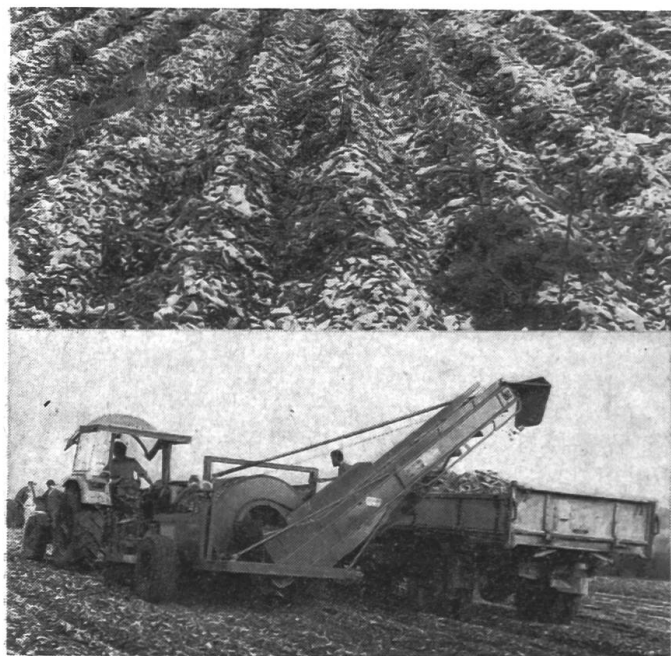
Fig. 9: L'épierreage des sols argileux du Jura, en automne, exige une préparation des champs et requiert des exigences toutes particulières des organes de criblage des épierreurs (taux de pierres important, juste avant la récolte des pommes de terre).
