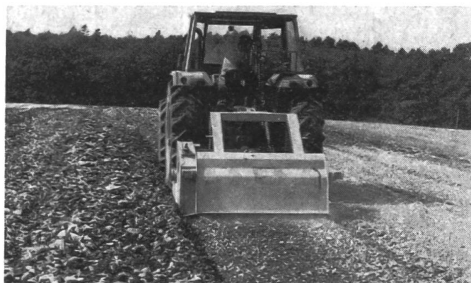
Fig. 12: Le concassage des pierres calcaires du Jura dans des sols argileux avec le modèle Nicolas est une méthode prometteuse, par rapport à l'épierrage. Ce travail ne modifie pas le volume de la couche arable.
