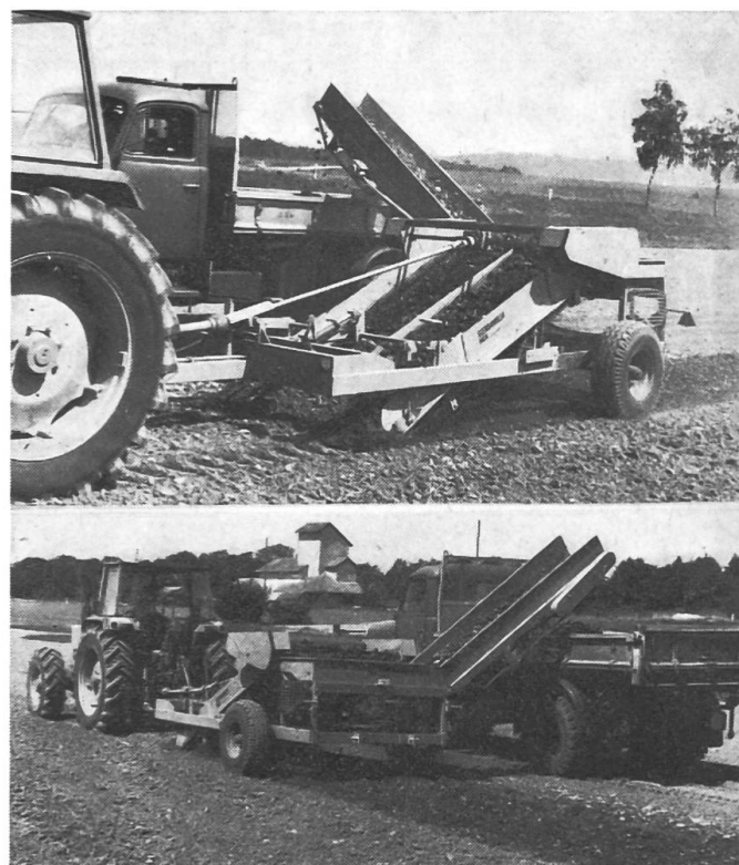
Fig. 6: L'épierreux MCA avec chaînes cribleuses et bande de chargement peut travailler jusqu'à 15 cm de profondeur. La terre est criblée en partie sur la bande de chargement mais principalement sur les chaînes cribleuses.
