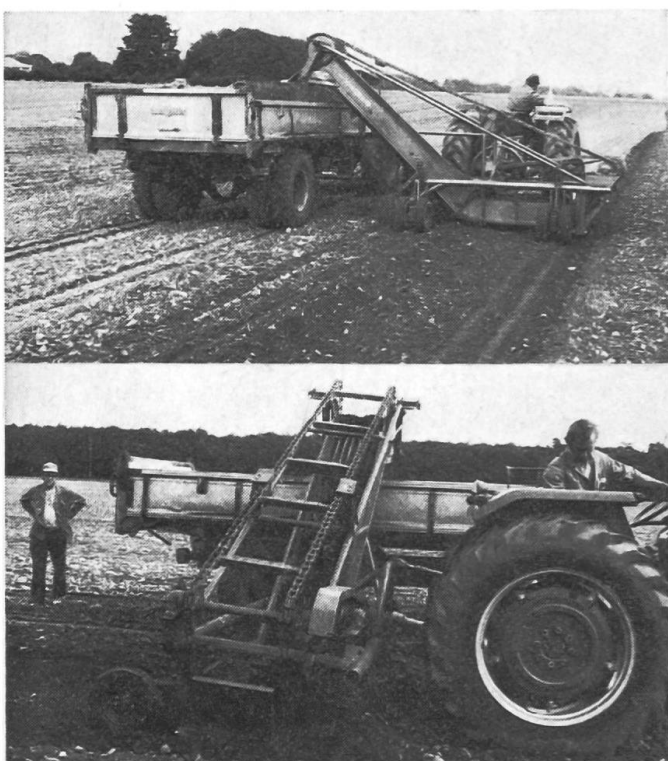
Fig. 5: Voici l'épierreux Kvernelands avec grille cribleuse et entraîneur. Sa profondeur de travail est limitée à 5-10 cm à cause de sa capacité de criblage minime.
