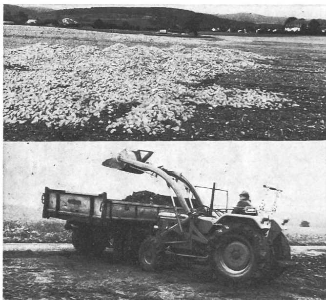
Fig. 4: Le chargement des pierres par un chargeur frontal exige un temps considérable, mais se justifie pour des parcelles petites et irrégulières.
