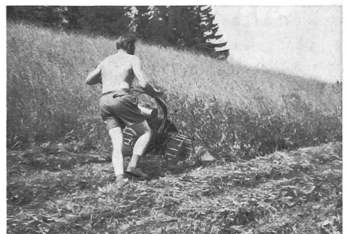
Fig. 5: Des roues-cages (comme ici) ou des roues jumelées augmentent la sécurité sur les terrains en pente et facilitent la conduite de la motofaucheuse ou du motofaneur lorsqu'on travaille selon le sens des courbes de niveau.
