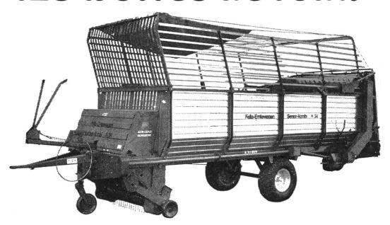
Les autochargeuses Peggy, surbaissées, avec une capacité de 18 et 22 m³ de fourrage sec avec au maximum 12 couteaux sont les petites parmi le grand assortiment d'autochargeuses FELLA.
