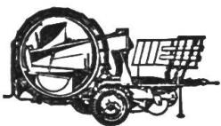
**SR** pour expl. petites, avec plate-forme ou trémie basculante contenance 900 kg.
