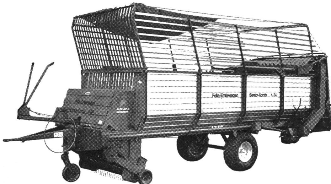
**Les autochargeuses Peggy**, surbaissées, avec une capacité de 18 et 22 m<sup>3</sup> de fourrage sec avec au maximum 12 couteaux sont les petites parmi le grand assortiment d'autochargeuses FELLA.
