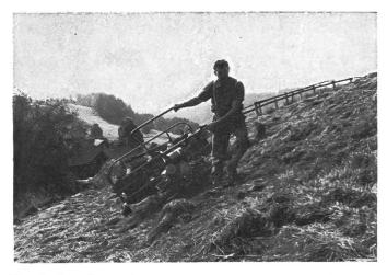
Fig. 2: Le râteau faneur peut se monter actuellement avec peu de travail sur la motofaucheuse. Cette solution est spécialement rentable dans les exploitations de montagne qui possèdent une faneuse à toupies.
