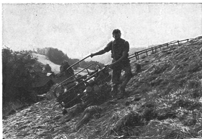
Fig. 2: Le râtelier faneur peut se monter actuellement avec peu de travail sur la motofaucheuse. Cette solution est spécialement rentable dans les exploitations de montagne qui possèdent une faneuse à toupies.
