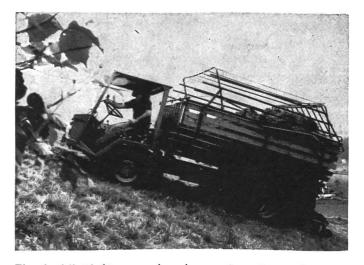
Fig. 4: L'intérêt pour le char automoteur chargeur dans les exploitations de montagne va en grandissant. Si le chargeur se monte et se démonte facilement, il peut très bien être utilisé avec la faneuse à toupies.
