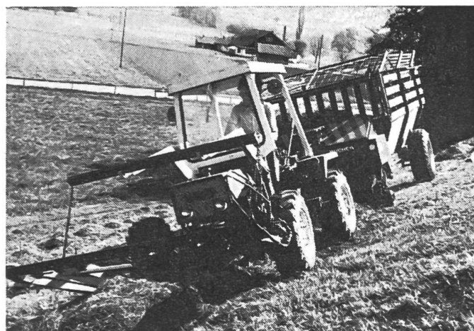
Fig. 3: Afin que l'on puisse remplacer une motofaucheuse par une faucheuse à 4 roues motrices, il faut qu'elle soit adaptée aux terrains déclinés. Elle ne peut être le seul moyen de traction, sauf dans certains cas, étant donné que son aptitude aux terrains déclinés avec chargeur ou épandeur de fumier ne dépasse pas celle d'un tracteur à 4 roues motrices.
