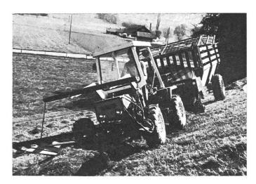
Fig. 3: Afin que l'on puisse remplacer une motofaucheuse par une faucheuse à 4 roues motrices, il faut qu'elle soit adaptée aux terrains déclives. Elle ne peut être le seul moyen de traction, sauf dans certains cas, étant donné que son aptitude aux terrains déclives avec chargeur ou épandeur de fumier ne dépasse pas celle d'un tracteur à 4 roues motrices.
