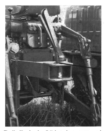
Fig. 1b: Une broche d'attelage de ce genre représente une bonne solution, car elle est à la portée du conducteur assis sur son siège et facilement verrouillable.
