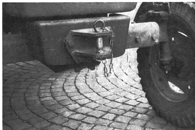
Fig. 1a: Cette chape d'attelage montée à l'avant comporte une broche d'attelage avec système de sûreté approprié. Elle convient pour pousser occasionnellement des véhicules et des machines mais ne convient pas à l'arrière du tracteur.
