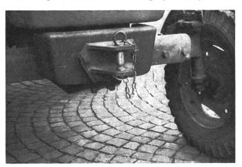
Fig. 1a: Cette chape d'attelage montée à l'avant comporte une broche d'attelage avec système de sûreté approprié. Elle convient pour pousser occasionnellement des véhicules et des machines mais ne convient pas à l'arrière du tracteur.
