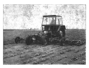
Fig. 4: Le châssis porte-outils automoteur Fendt F 275 GT (51 kW/70 ch) équipé d'une sarcleuse à betteraves (largeur de travail: 6 m) permet de travailler à l'heure une superficie représentant jusqu'à 3 hectares. Une articulation centrale et des roues de guidage supplémentaires assurent la très bonne adaptation de cette machine aux inégalités du sol.
