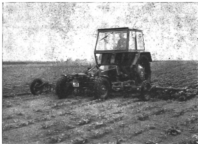
Fig. 4: Le châssis porte-outils automoteur Fendt F 275 GT (51 kW/70 ch) équipé d'une sarclieuse à betteraves (largeur de travail: 6 m) permet de travailler à l'heure une superficie représentant jusqu'à 3 hectares. Une articulation centrale et des roues de guidage supplémentaires assurent la très bonne adaptation de cette machine aux inégalités du sol.
