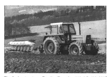
Fig. 3: Le tracteur Fendt «Favorit» 612 LS (88 kW/120 ch) avec une charrue portée demi-tour à six corps. Le puissant moteur à six cylindres de cette machine, sa boîte de vitesses bien étagée et entièrement synchronisée et ses quatre roues motrices permettent de travailler la plus importante surface possible à l'heure lors des labours.
