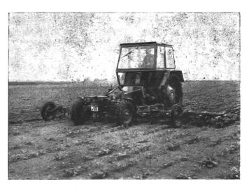
Fig. 4: Le châssis porte-outils automoteur Fendt F 275 GT (51 kW/70 ch) équipé d'une sarcleuse à betteraves (largeur de travail: 6 m) permet de travailler à l'heure une superficie représentant jusqu'à 3 hectares. Une articulation centrale et des roues de guidage supplémentaires assurent la très bonne adaptation de cette machine aux inégalités du sol.
