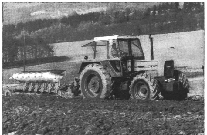
Fig. 3: Le tracteur Fendt «Favorit» 612 LS (88 kW/ 120 ch) avec une charrue portée demi-tour à six corps. Le puissant moteur à six cylindres de cette machine, sa boîte de vitesses bien étagée et entièrement synchronisée et ses quatre roues motrices permettent de travailler la plus importante surface possible à l'heure lors des labours.
