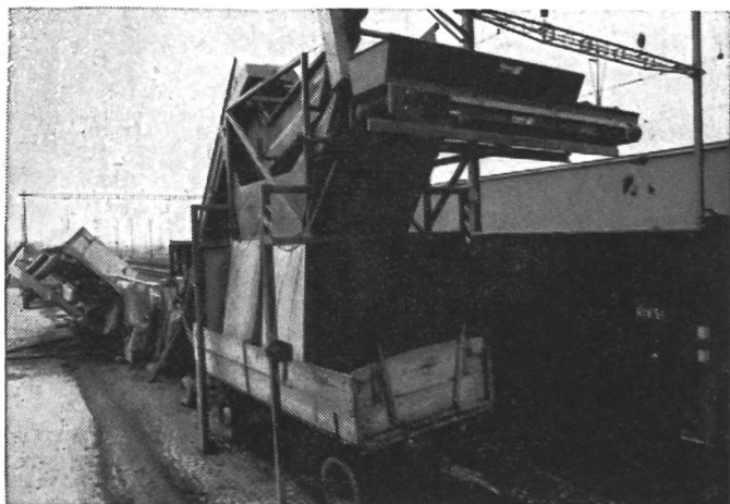
Fig. 4: Dispositif d'élimination de la terre à deux gradins accolé à un transporteur-chargeur transversal orientable et monté sur un bâti, ce qui permet d'amener facilement un véhicule au-dessous pour l'évacuation de la terre. (Installation utilisée à Dotzigen BE)
