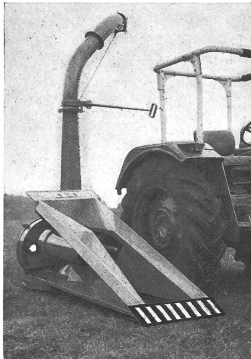
Fig. 3: Hâcheuse-ensileuse à maïs, avec tôle de signalisation fonctionnant également comme protection.
