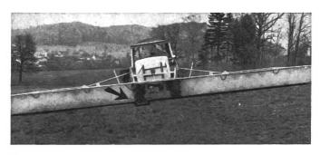
Fig. 2: Lors de la pulvérisation sur terrain en pente en courbe de niveau, les pneumatiques des tracteurs s'aplatissent par le déplacement du centre de gravité. Grâce au dispositif compensatoire d'inégalités de terrain, le pulvérisateur peut être réglé horizontalement par rapport au sol (Birchmeier).
