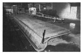
Fig. 4: Mesurage de la répartition transversale du banc d'essai à caniveau, avec 10 cm de distance du caniveau.
