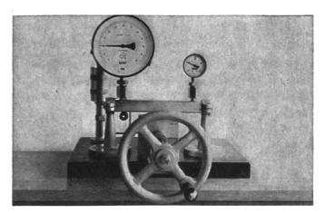
Fig. 6: Contrôle de l'exactitude de l'indicateur des manomètres avec le manomètre-test, à gauche.
