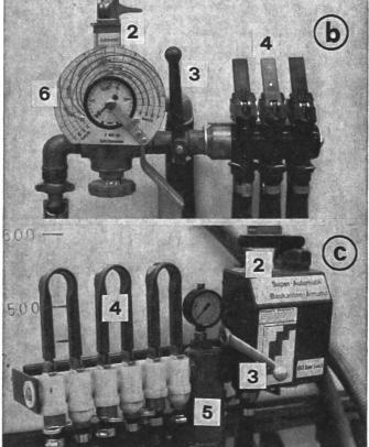
Fig. 7: Exemples d'ensembles distributeurs-régulateurs, à trois amenées de bouillie:
