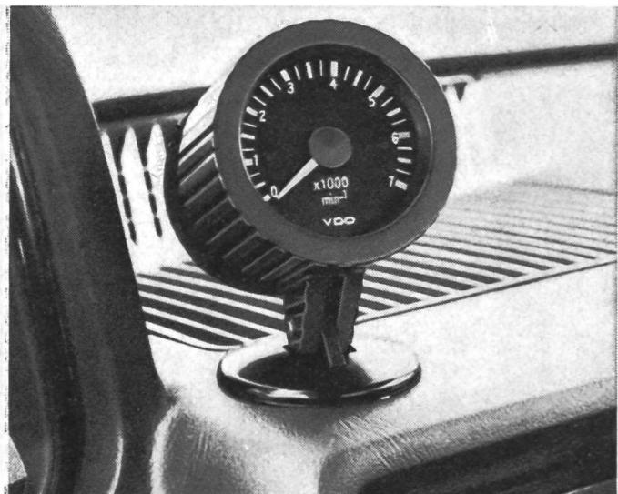
de mesure 7000 min<sup>-1</sup>, prévu pour tous les moteurs 4-temps à 4 cylindres.
