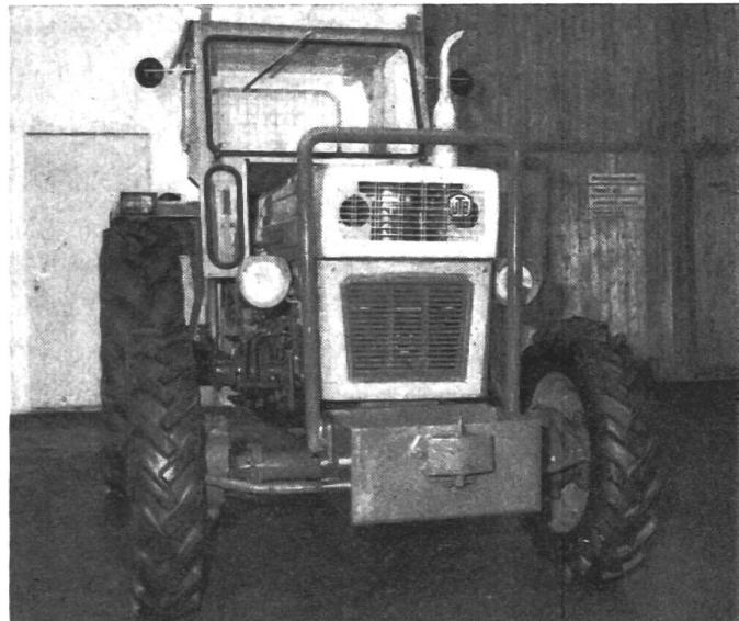
côtés du tracteur. Sinon l'écorce des arbres risque d'être endommagée. C'est pourquoi les garde-boue arrière avec siège ont été montés légèrement en retrait (d'environ 5 cm). Ce sont les pneus du tracteur qui représentent les parties extérieures extrêmes. Il en va de même des pneus de l'essieu moteur avant, vu qu'aucune boîte de vitesses à planétaires ne dépasse latéralement.
