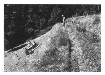
Fig. 7: Une faucheuse automotrice à quatre roues possédant les aptitudes voulues pour être utilisée sur les terrains en pente est capable de fournir un rendement de travail important à l'heure et on peut l'employer avec sécurité jusqu'à un taux d'inclinaison de 65%. Les machines qui possèdent une grande sûreté de fonctionnement et qu'on met en œuvre avec une faucheuse rotative à tambours ou à disques ne demandant que peu d'entretien offrent les conditions voulues pour une utilisation en commun.
