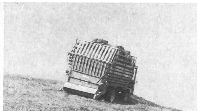
Fig. 5: Le char automoteur avec dispositif ramasseur-chargeur à l'arrière pose de temps en temps des problèmes quand il travaille selon le sens des courbes de niveau sur des pentes de forte inclinaison. Les avantages qu'il présente par contre de pouvoir être facilement utilisé avec d'autres matériels portés et avec l'épandeur-faneuse tractée à toupies apparaissent très clairement avec certains modèles.
