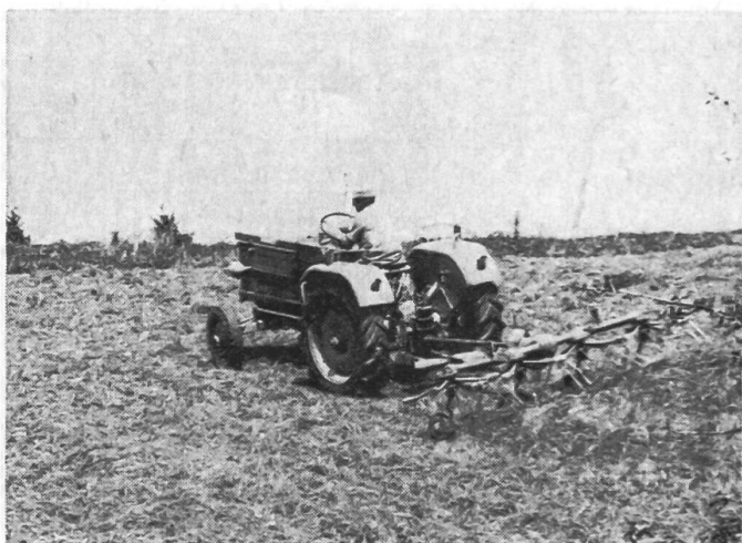
Fig. 6: Le tracteur normalement équipé peut être mis en service sur des terrains déclives d'un taux d'inclinaison allant jusqu'à 35%. Les agriculteurs conscients de leurs responsabilités ne roulent sur de telles pentes qu'avec une machine pourvue d'un cadre de sécurité.
