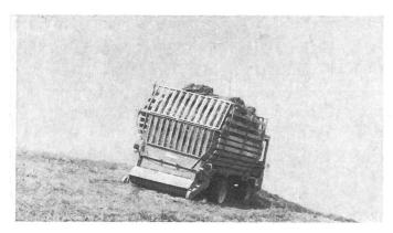
Fig. 5: Le char automoteur avec dispositif ramasseurchargeur à l'arrière pose de temps en temps des problèmes quand il travaille selon le sens des courbes de niveau sur des pentes de forte inclinaison. Les avantages qu'il présente par contre de pouvoir être facilement utilisé avec d'autres matériels portés et avec l'épandeuse-faneuse tractée à toupies apparaissent très clairement avec certains modèles.
