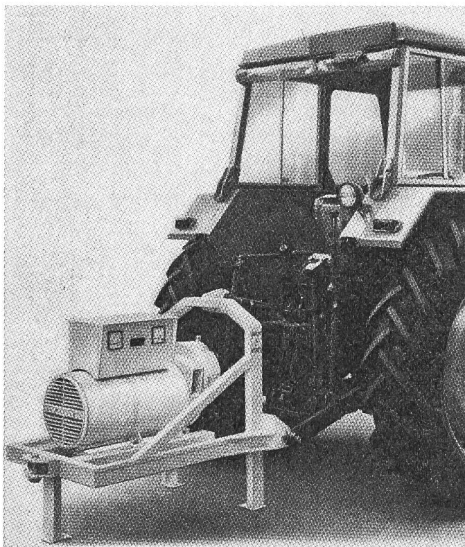
Fig. 4: Générateur de prise de force portatif, fixé avec tige à 3-points. Puissance 25 kVA.
