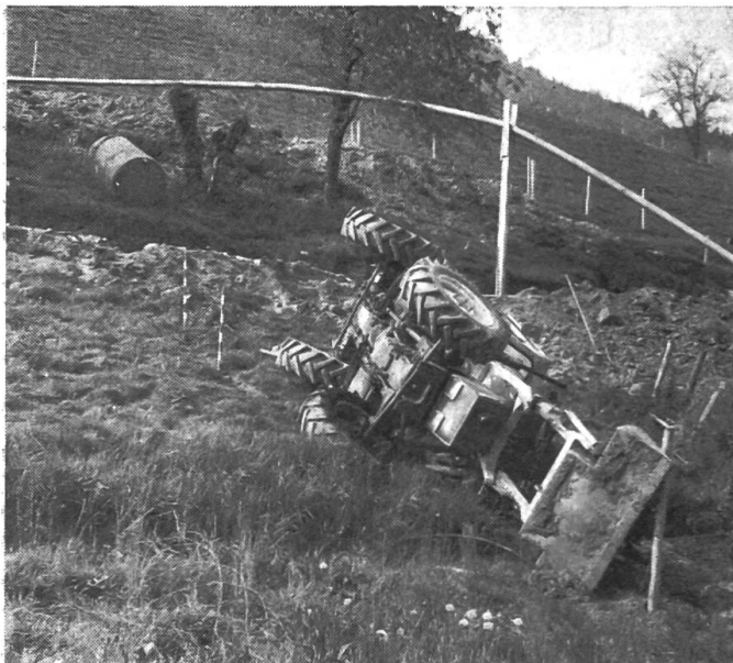
Fig. 2: Le déplacement du centre de gravité de la machine provoqué par le chargeur hydraulique frontal a eu pour conséquence que ce véhicule de traction à quatre roues motrices spécialement prévu pour être utilisé sur les terrains en pente s'est renversé d'arrière en avant et obliquement sur un champ de forte déclivité.
