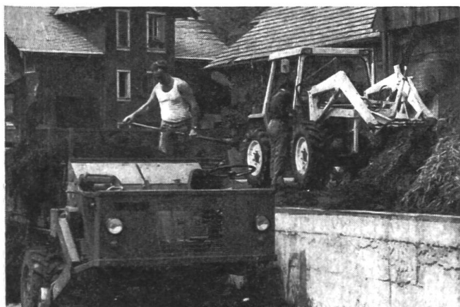
Fig. 4: Le chargeur frontal du tracteur universel UT 5000 chargeant du fumier sur le char automoteur TR 1600.
