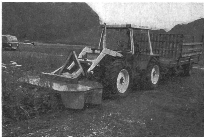
Fig. 2: Le tracteur universel UT 6500 équipé d'une faucheuse rotative à l'avant et tirant une remorque autochargeuse.
