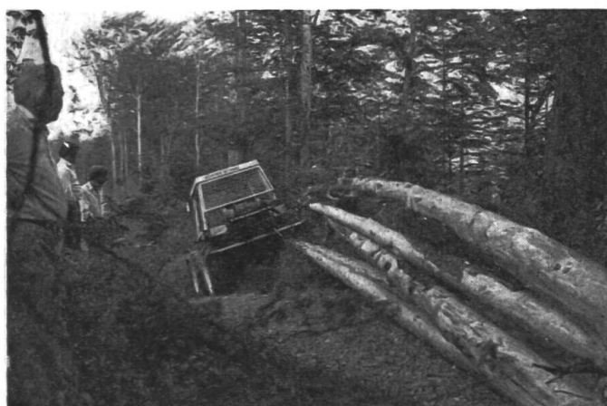
Fig. 5: Le tracteur forestier UT 6500 (tracteur universel équipé d'un double treuil et d'une lourde plaque d'ancrage).
