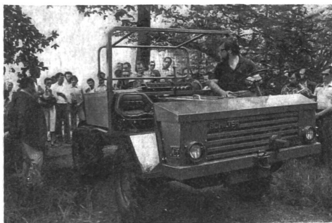
Fig. 6: Le tracteur forestier 2500 F (char automoteur muni d'un seul treuil et d'une plaque d'ancrage).
