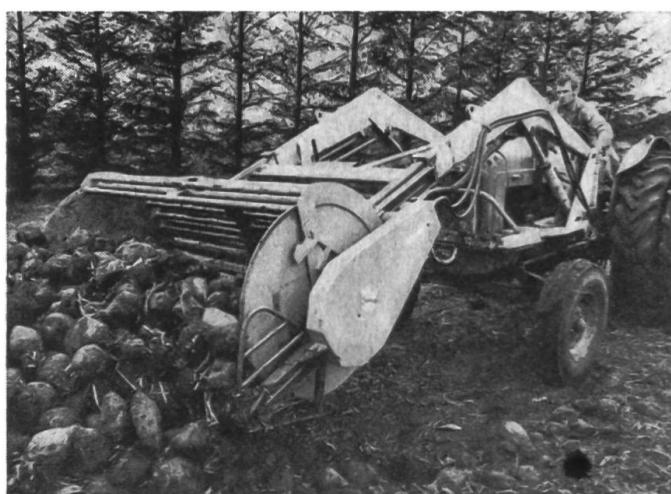
Le tambour-nettoyeur, actionné par un moteur hydraulique, tourne pendant la marche avant ou arrière du tracteur. Cela permet d'obtenir un nivellement régulier de la terre retombée. Le nettoyage est bien fait et s'opère avec ménagement grâce à la construction du tambour à tuyaux. Le chargeur est construit en «RHS-PROFIL» dur et s'adapte à chaque chargeur frontal. Le tracteur doit être muni d'une soupape de commande.
