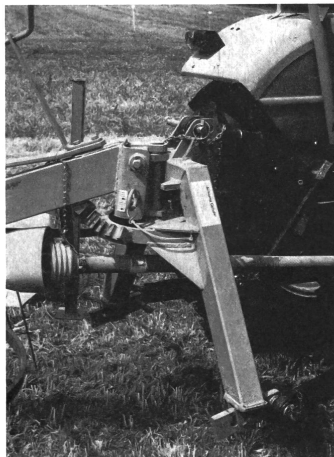
Fig. 3: Tous les râteaux rotatifs sont vendus aujourd'hui avec un chevalet articulé (illustration) ou avec un autre dispositif pivotable.
