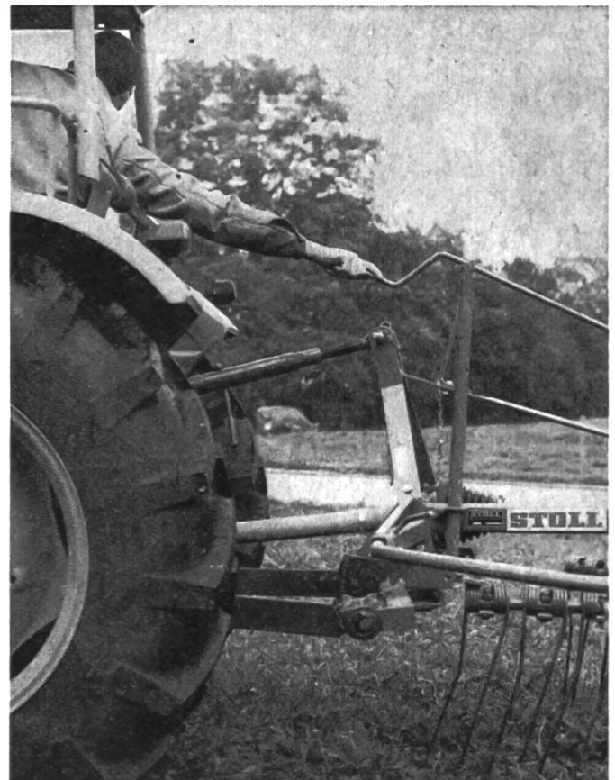
Fig. 4: Les réglages en hauteur ne se justifient que s'ils sont placés à la portée du conducteur.
