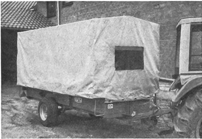
Fig. 2: La même remorque recouverte d'une bâche en matière plastique et d'une fenêtre. On peut y prendre place durant les transports et les interruptions de travail.
