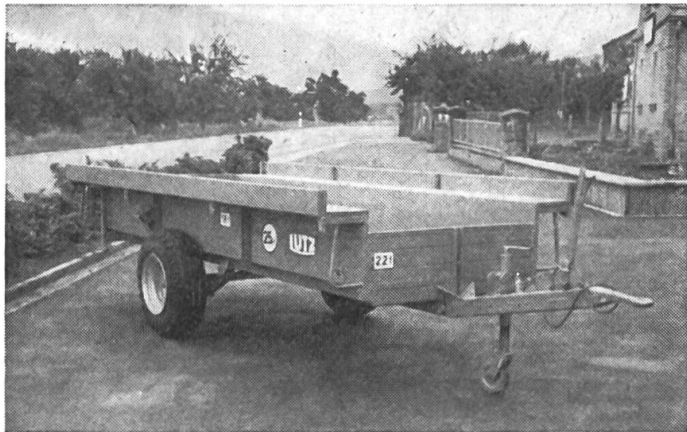
Fig. 1: Remorque spéciale à châssis surbaissé pourvue de bancs sur les ridelles.
