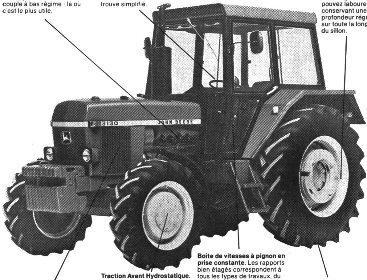
**Système hydraulique en circuit fermé.** Une seule pompe externe fournit la puissance hydraulique instantanément lorsque c'est nécessaire, ceci sans action constante de la pompe. La transmission et le circuit hydraulique partagent la même huile.
