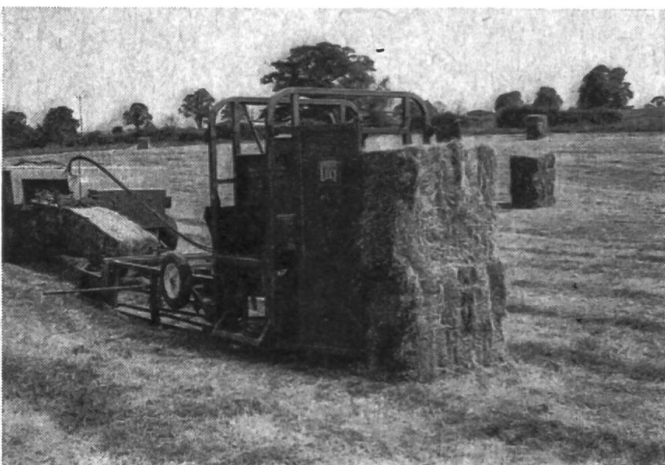
Cette machine met automatiquement huit balles de foin ou de paille en tas, en les entrecroisant, et en forme un cube.
